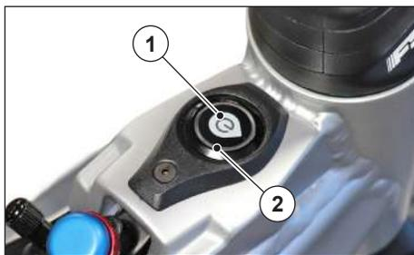
Premendo e mantenuto premuto il tasto (1) per qualche secondo si avvia il sistema, la ghiera (2) si illumina di colore verde fisso indicando nessuna assistenza alla pedalata, ogni due secondi la ghiera lampeggia indicando il livello di carica della batteria.
